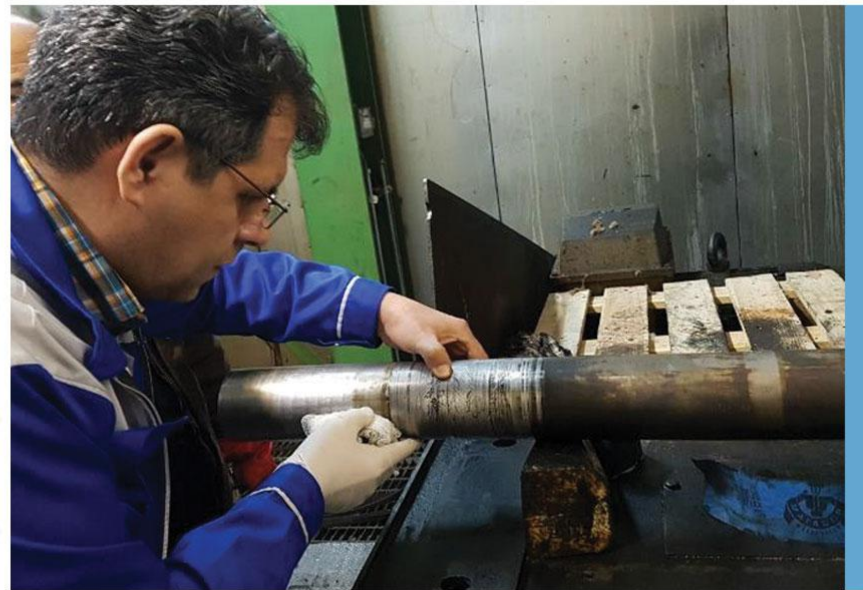
▴ نصب بیرینگ به روش Drive up method در صنایع لاستیک زنجان ▽
