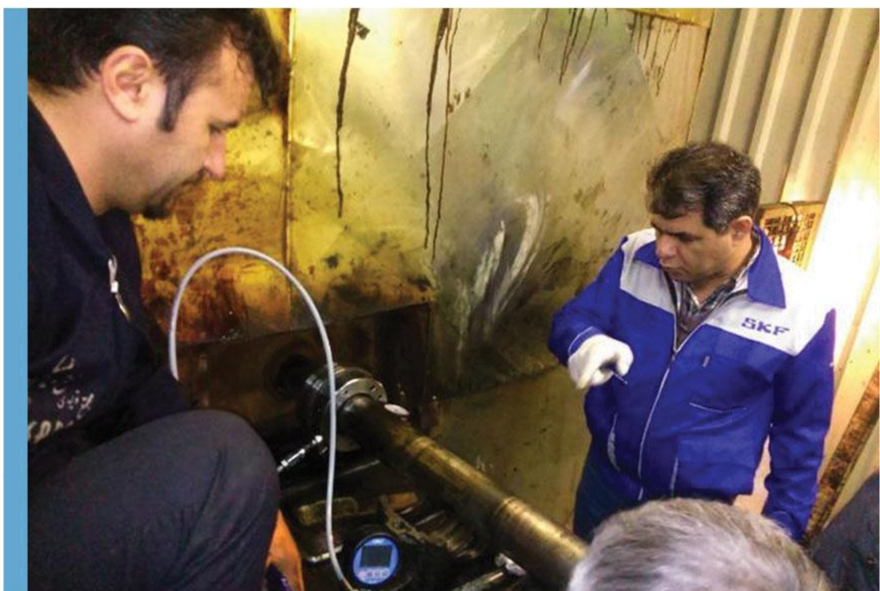
▴ نصب بیرینگ به روش Drive up method در صنایع لاستیک زنجان ▽
